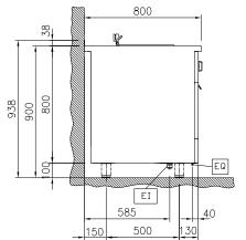
Electrical inlet (power) EQ **Equipotential screw**
